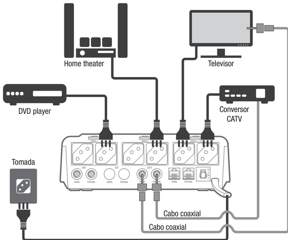
**⚠ IMPORTANTE:** É necessário e fundamental para o funcionamento do protetor de TV, que a tomada onde for ligado possua terminal de aterramento. Sem aterramento, a função que detecta fase e neutro invertidos não funcionará. Também as proteções de rede elétrica não funcionarão corretamente.
