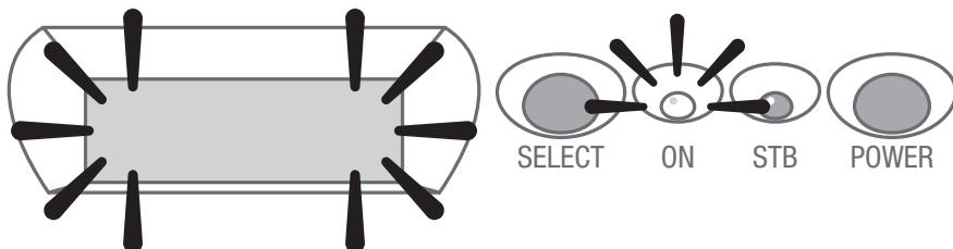
**LED para indicação de funcionamento** e o **display indicador de funções** acendem após o **botão POWER** ser pressionado.
