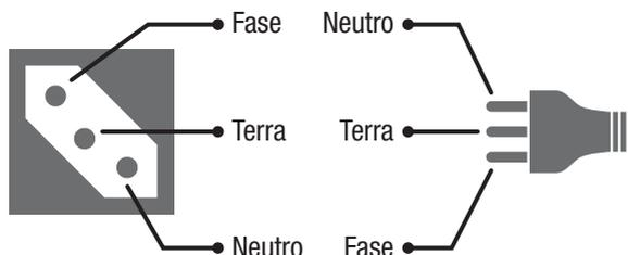
**ATENÇÃO:** Um bom aterramento é indispensável para o funcionamento do estabilizador. Não se consegue um aterramento ligando o terra do aparelho ao neutro da rede elétrica ou utilizando peças metálicas que não sejam para este fim. Qualquer dúvida, consulte as normas de instalação da empresa responsável pelo fornecimento de energia elétrica. O estabilizador deve ser instalado próximo a tomada da rede elétrica e esta deve ter fácil acesso.
