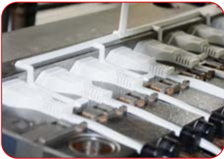
Injeção de plugues
